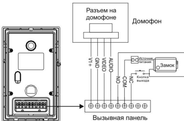
Подключение вызывной видеопанели, электромагнитного замка и кнопки выхода при питании замка от внешнего источника питания:
