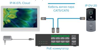
Схема 2. Топология подключения ІР системы видеодомофонии с использованием обычного сетевого коммутатора.
