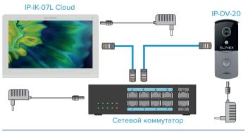
Схема 3. Топология подключения IP системы видеодомофонии без использованиия сетевого коммутатора (до 2-х устройств в сети).
